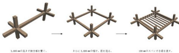
3,600mm の長さで接合部を繋ぐ。 さらに 3,600mm の幅で、面を造る。 600mm のスパンで小梁を選ぶ。
