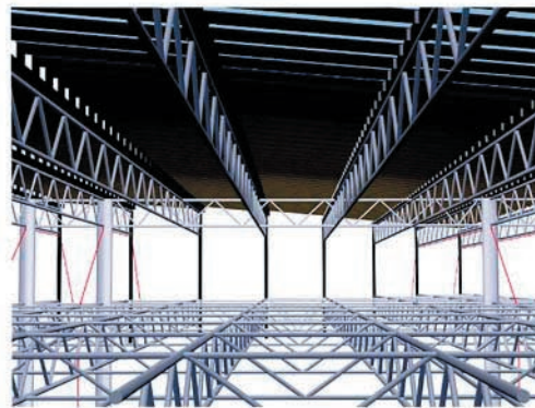
長手方向に 1 m ピッチ間隔で配置された木材はソーラーパネルを支えると同時に小梁の役割を果たす。
